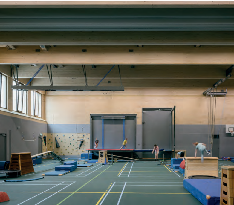
In het plafond van de sportzaal zijn wel grote houten liggers gebruikt.
