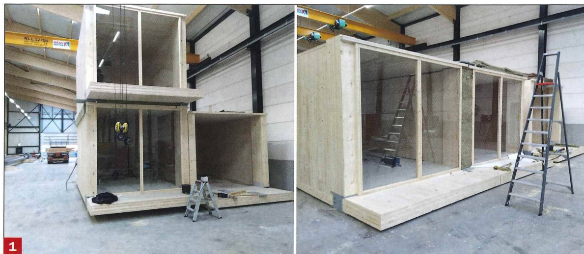
Houtkern-modules (Circlewood) in verticale (links) en horizontale opstelling (rechts) – 1 e geluidmetingen (2021)
