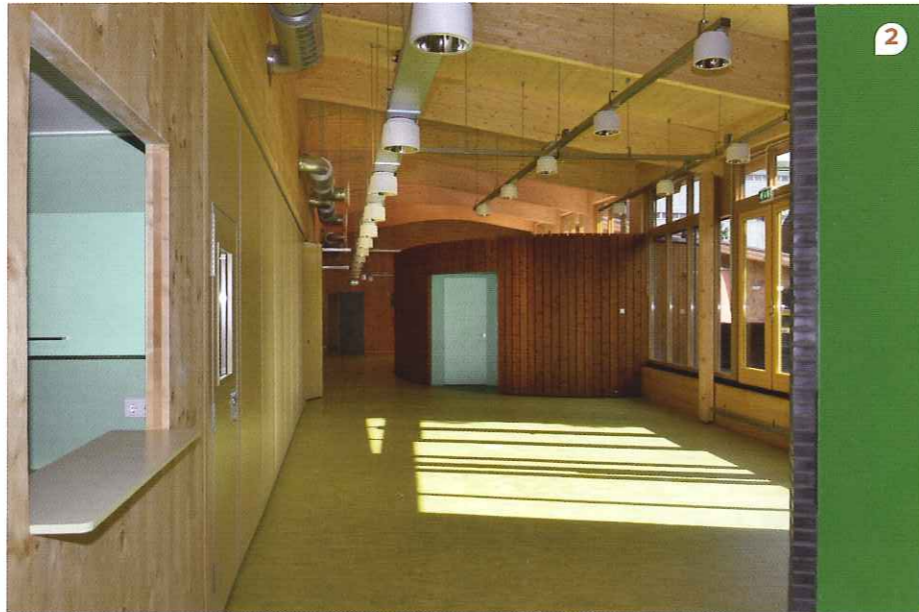
1 // Door het kruislaaghout konden de meeste kolommen vervallen. Die staan nog alleen daar waar de gevelopeningen doorlopen tot de dakrand. 2 // Toiletten en andere voorzieningen zijn als losse interieurelementen in de gangzone geplaatst. 3 // In de puien zijn Plato-wood en gekleurde stroken Trespa toegepast. De gevel valt vooral op door de gebruikte steen. Dit is een nieuw product van Daas Baksteen, genaamd DuecoPanel, met het uiterlijk van boomschors. Het is een keramische steen van 20 cm hoog en 30, 40 of 50 cm lang. De verschillende bloklengtes zijn in wild verband verwerkt. Doordat gekozen is voor lijmen, is geen voeg zichtbaar. Het blok is slechts 70 mm dik en is hol. Dat scheelt 55 procent materiaal vergeleken met traditioneel metselwerk. Daarbij zet Daas bij zijn productie in op duurzame energie en technieken.
